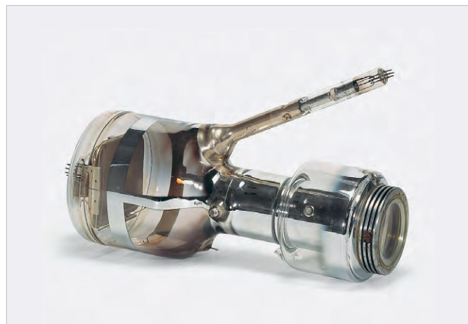
Рис. 3. Фактический вид супериконоскопа Зворыкина
