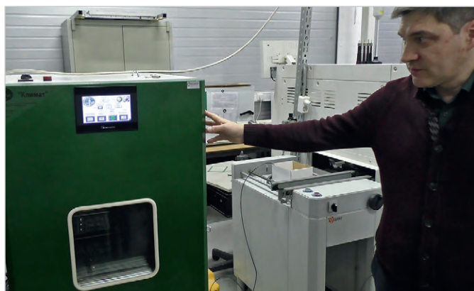
Рис. 3. Климатическая установка для сушки компонентов и проведения климатических испытаний готовых изделий
