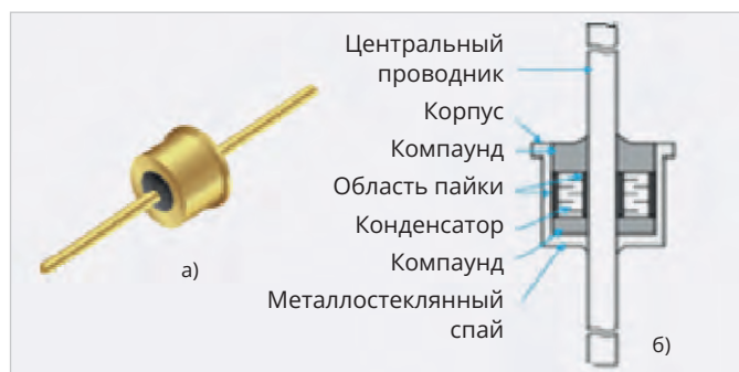
Рис. 1. Миниатюрные герметичные безрезьбовые С-фильтры: а) внешний вид, б) конструкция
