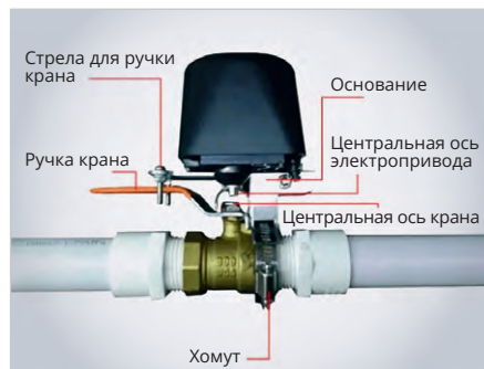
Рис. 5. Электропривод с водопроводным шаровым краном
