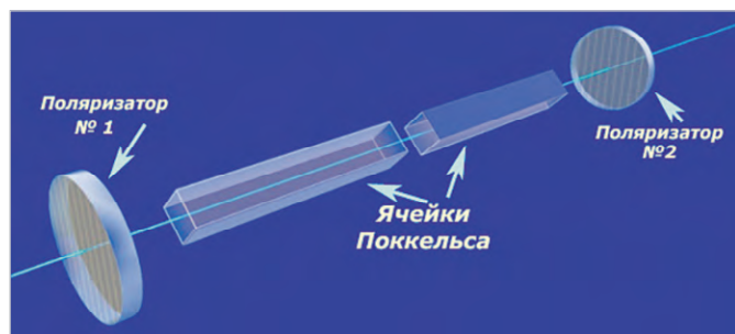
Рис. 2. Структурная схема электрооптического амплитудного модулятора с двумя поляризаторами и ячейками Поккельса (PC)
