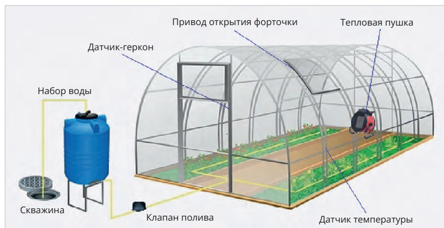
Рис. 6. Пример плана размещения оборудования для теплицы
