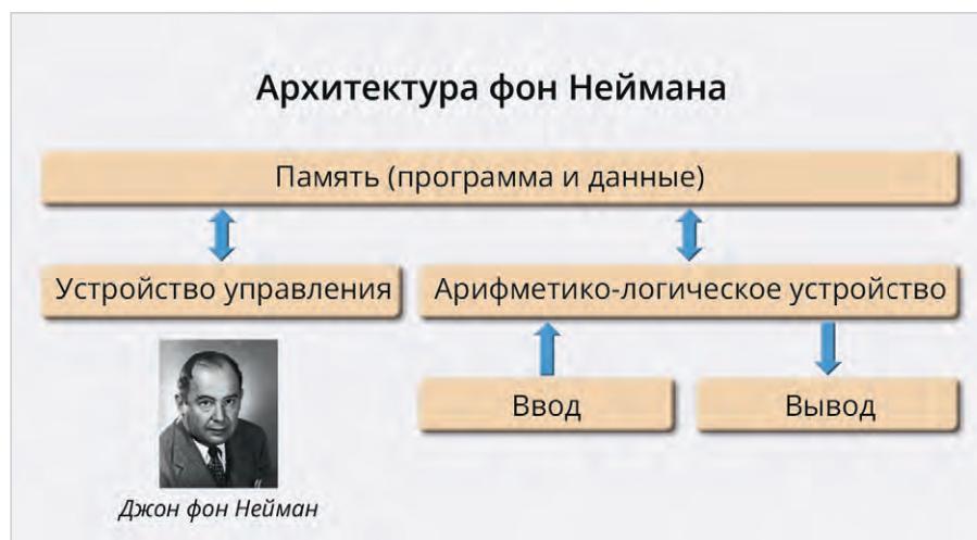
Рис. 2. Функциональная схема архитектуры Фона-Неймана
