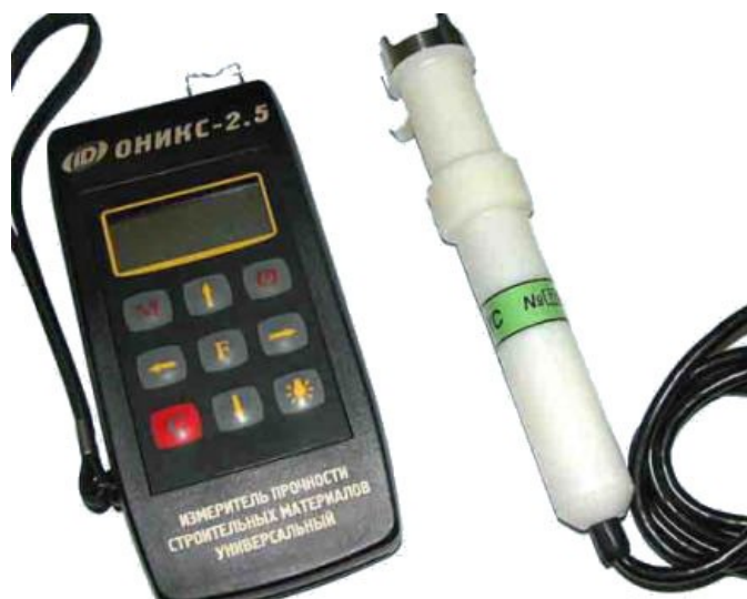
Рис.6.6 Общий вид прибора «Оникс-2.5»
