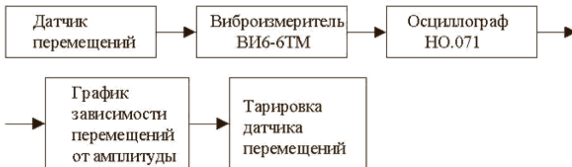
Рис. 6.6. Принципиальная схема передачи измерительной информации при тарировке датчика перемещений
