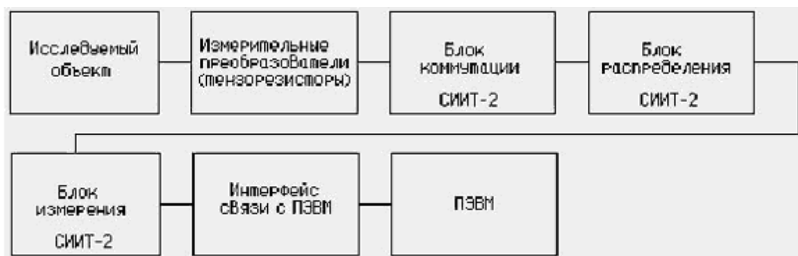
Рис.4.3. Схема передачи сигнала измерительной информации от тензорезистора в память ПЭВМ
