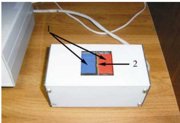
Объект исследования конструктивно выполнен в виде сборного корпуса, в котором установлены электромагнит (1) и датчик Холла (2). Сверху объект исследования имеет окно, через которое видны полюса электромагнита и плата с датчиком Холла. Для подключения объекта
