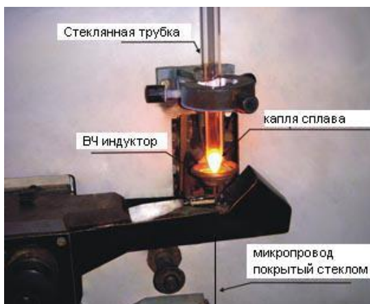
Рисунок 1.3 – Фотография установки для производства микропровода
