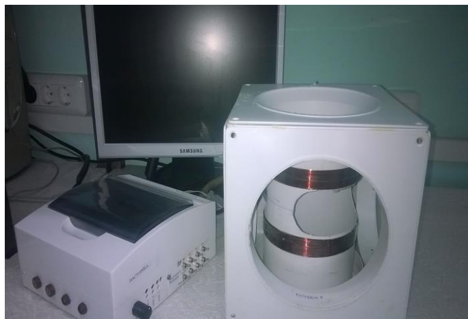
Рисунок 2.12 – Фотография магнитокомпенсационного стенда
