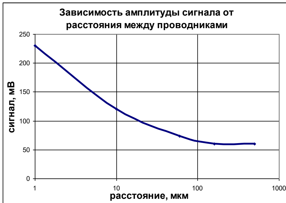
Рисунок 3.30 – Зависимость амплитуды сигнала ЧЭ на подложке от расстояния между МИ проводниками на частоте 8 МГц
