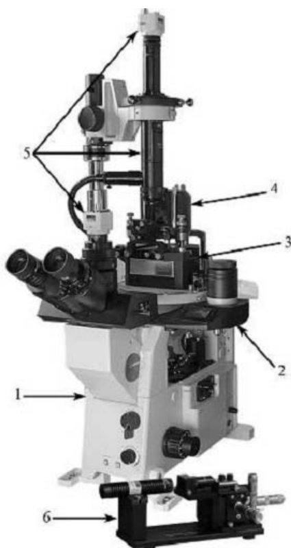
Рис. 65. Общий вид ЗНЛ Интегра Соларис. 1-инвертированный оптический микроскоп, 2- базовый блок Интегра, 3- сменное основание, 4- сканирующая измерительная головка, 5- система видеонаблюдения, 6-лазерный модуль
