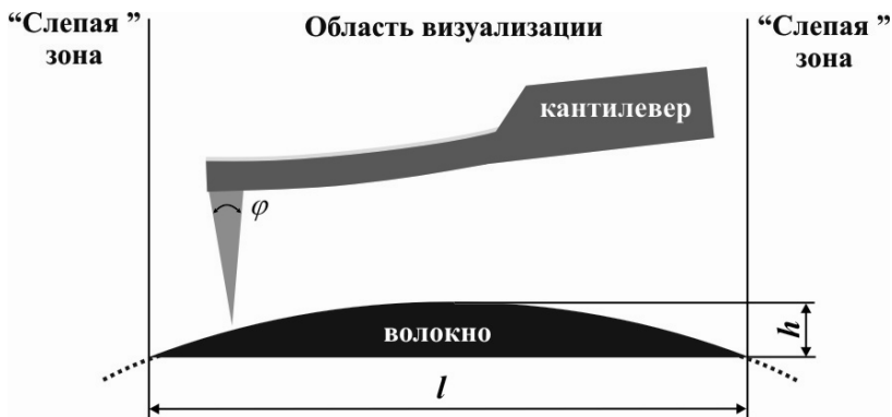
Рис. 78. Схематическое изображение процесса сканирования волокна в атомно-силовом микроскопе
