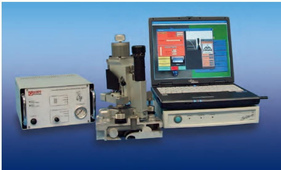
SINT Technology, партнер HBM, предлагает измерительные цепочки MTS3000, которые позволяют упростить реализацию метода высверливания отверстия. Для создания отверстия используется резец, управляемый шаговым двигателем, со скоростью 400000 об./мин. Изменения деформации, возникающие при поэтапном высверливании отверстия в образце, измеряются с помощью розетки тензорезисторов (см. стр. 74), специально разработанной для этой цели.
