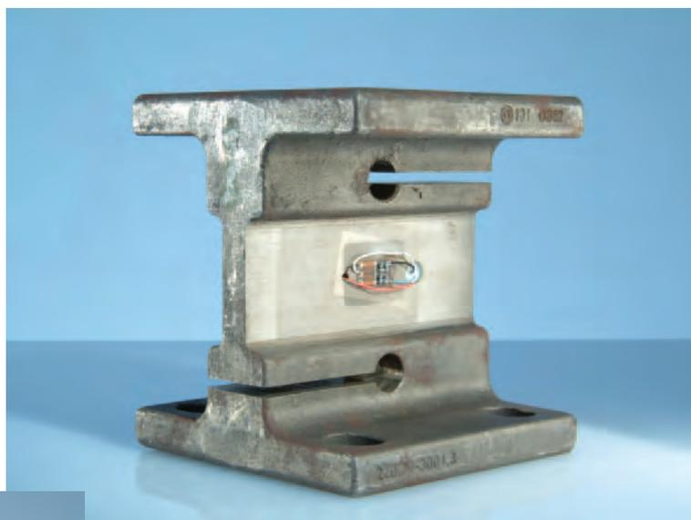
Установка тензорезистора на объект измерения
