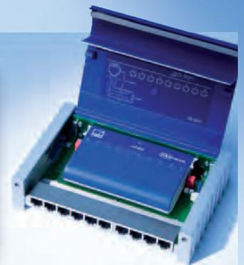
Подключение тензорезисторов к основному модулю CANHEAD CB1016 (тензорезисторы с разъёмом RJ11 несовместимы с платами VT810 и VT814)
