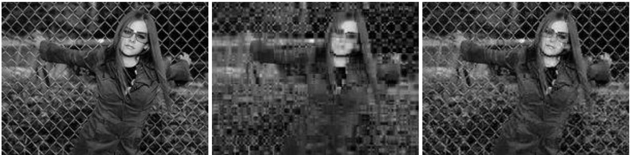
**Рис. 7. Пример сжатия изображения при помощи выделения главных компонент (слева-направо: исходное изображение, восстановленное при использовании 1-ой главной компоненты, при использовании 4-х главных компонент).**
