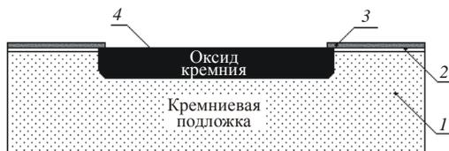
Рис. 6.17. Структура пластины кремния после изопланарного процесса:
