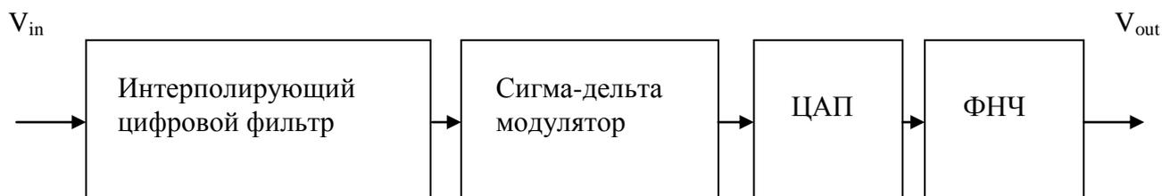
Рис. 7 — Блок-схема сигма-дельта ЦАП
