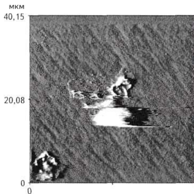
Рис. 19. Разрушение клетки при сканировании в результате самовозбуждения системы
