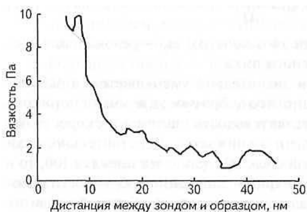
Рис. 33. Кривая силы, демонстрирующая резкое возрастание вязкости жидкости при приближении зонда к образцу
