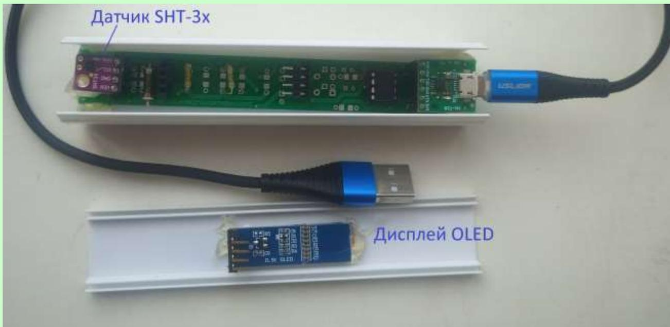
Рисунок 5. Разобранная конструкция измерителя
