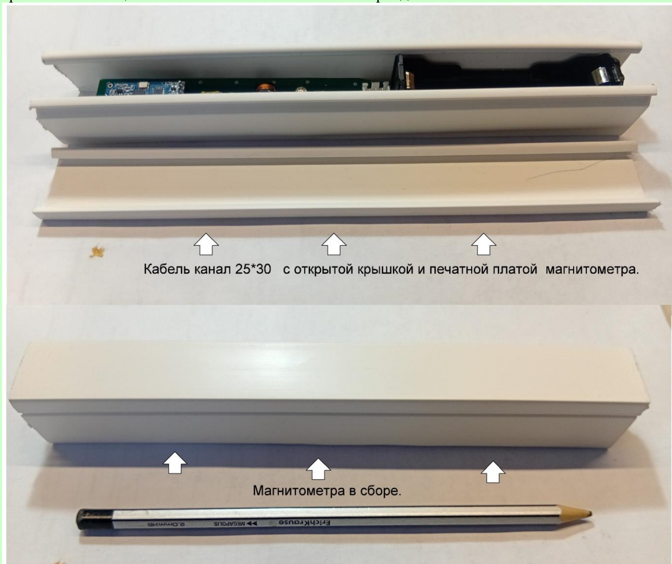
Рисунок 7. Магнитометр в сборе в корпусе кабель-канала.
