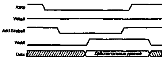
Рис. 1.5. Адресный цикл чтения EPP
