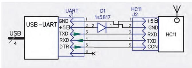
Рис. 2. Принципиальная схема системы радиосвязи в ЦИ
