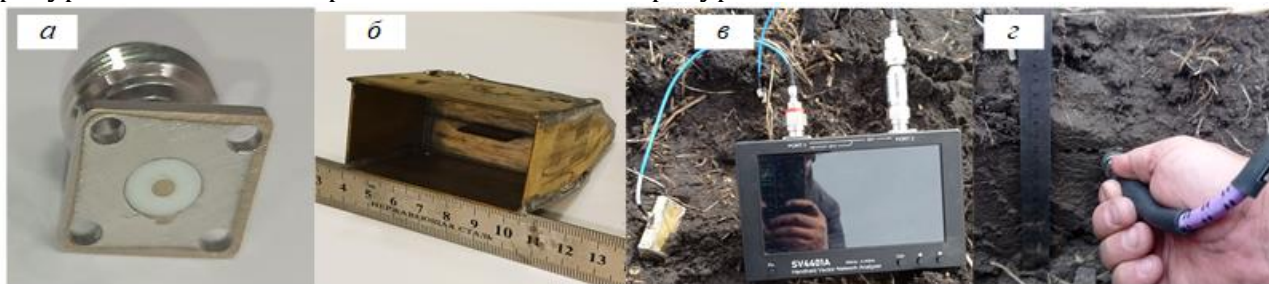
Рис. 1. а – Внешний вид датчика на основе открытого конца коаксиальной линии, б – внешний вид датчика на основе симметричной полосковой линии, в – векторный анализатор цепей SV4401A со вторым датчиком, г – измерения при помощи первого датчика в шурфе
