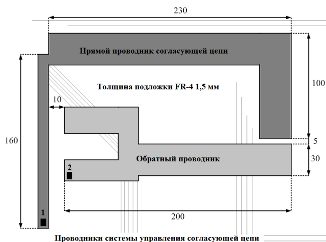
Рис. 1. Упрощенная топология прямого и обратного печатных проводников макета согласующей цепи с учетом проводников системы управления в обратном слое печатной платы согласующей цепи с указанными местами подключения векторного анализатора цепей (1,2)
