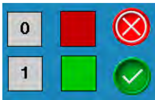
Рисунок 8.11. Способы индикации состояния входов устройства ввода дискретных сигналов
