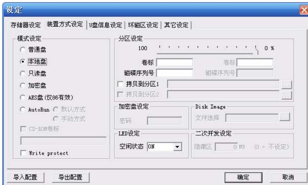
选择本地盘模式时，“Disk Image”设置项无效，可以进行分区，自定义卷标、磁碟序列号和设定 LED，具体操作可参考普通盘模式的说明，简体中文系统下量产出来的默认卷标是“本地磁盘”。
