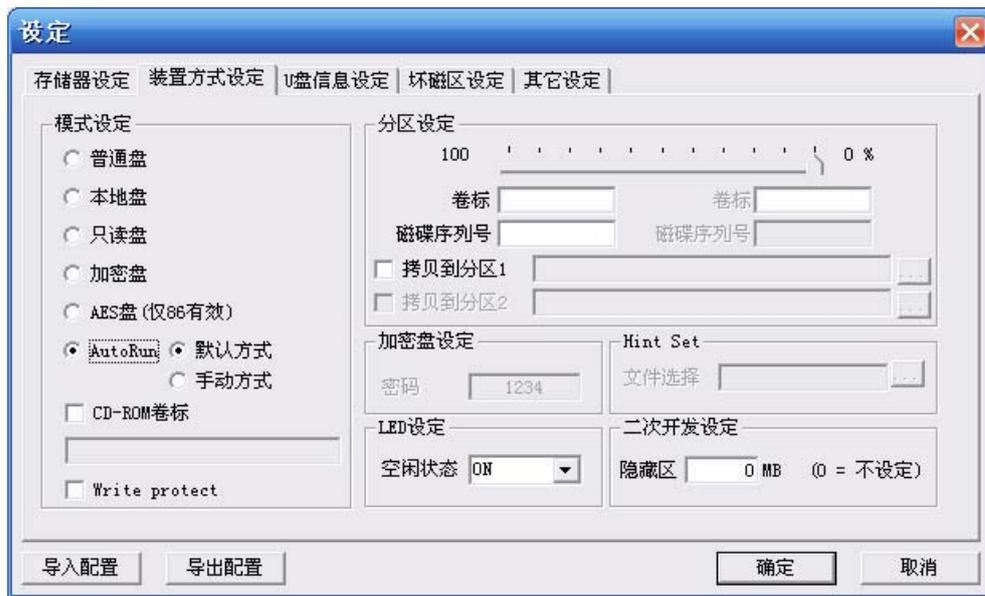
自动播放功能,将 C 盘根目录下的 9384.img 文件写到 CD 区中,将 Reserve.img 文件写到隐藏区中.从而生成一个 CD 区和一个可移动区,可移动区可以自行选择,用户可根据自己的意愿选择一个或者两个,我们另外会提供专门的工具来生成 9384.img 和 Reserve.img 这两个文件。
