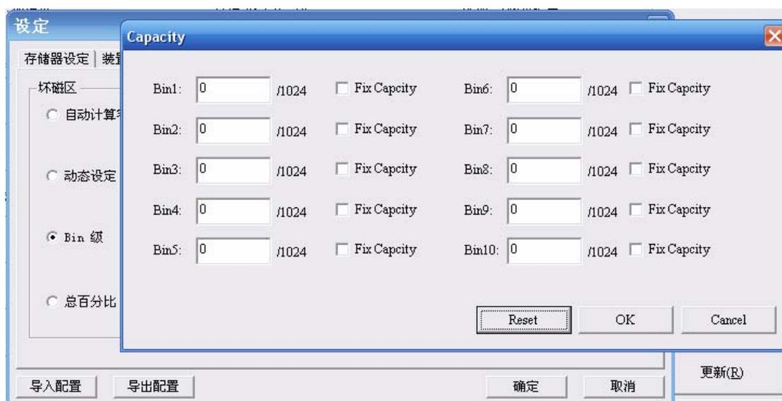
可根据容量设定 FLASH 的等级，量产工具会判断 FLASH 是属于哪个等级，并在量产完成之后显示在状态信息栏中。Bin1~Bin10 的设定值是一个百分比值，必须按照由大到小的顺序设置，每个等级的默认值都为 0，量产工具按照 Bin1 到 Bin10 的顺序进行判断。若不勾选等级后面的“FixCapacity”则量产出来的容量为实际容量，并会显示该 flash 是属于哪个等级的；若勾选等级后面的“FixCapacity”则会判断该 FLASH 是属于哪个等级并将它量产成容量与它所属的等级的容量大小一样。
