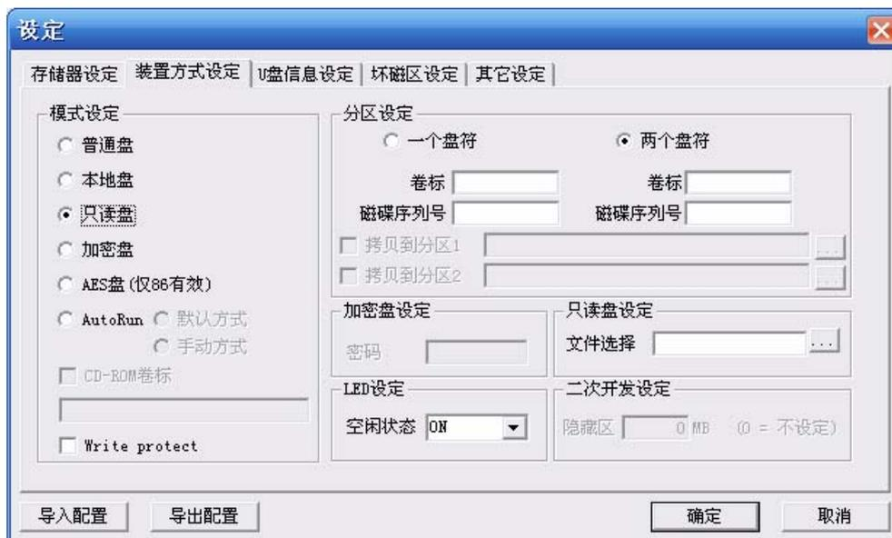
将 U 盘量产为只读盘，只能读取盘中的文件而不能对该盘做任何的操作。可选择量产为一个盘符或两个盘符，此时“拷贝到分区”无效，只读盘设定有效，可自定义卷标、磁碟序列号和设定 LED，具体操作可参考普通盘模式的说明。
