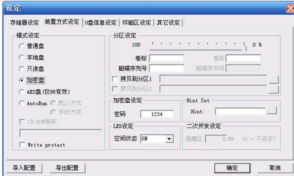
选择加密盘模式时，此时“加密盘设定”有效，可设定加密盘的初始密码，密码最大长度为 8 位，“只读盘设定”无效，可以进行分区，自定义卷标、磁碟序列号和设定 LED，具体操作可参考普通盘模式的说明。
