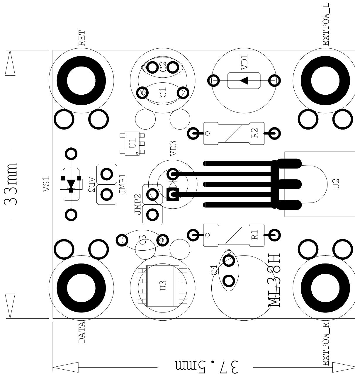
Схема размещения компонентов на плате ml38h, используемой для построения 1-Wire-микросистемы типа ML38H.
